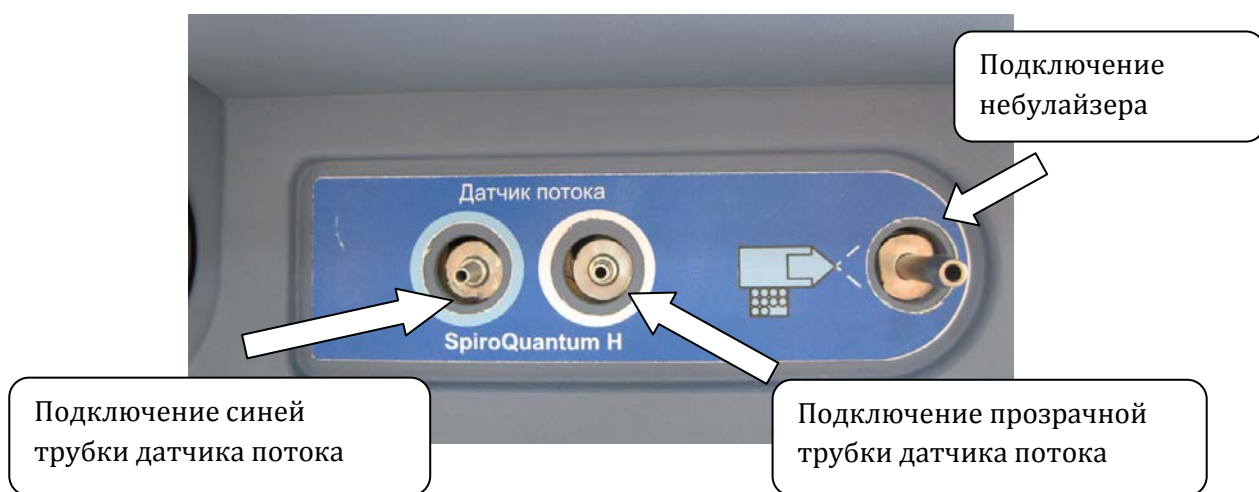
Рис. 5-7. Порты подключения датчика потока и небулайзера.
