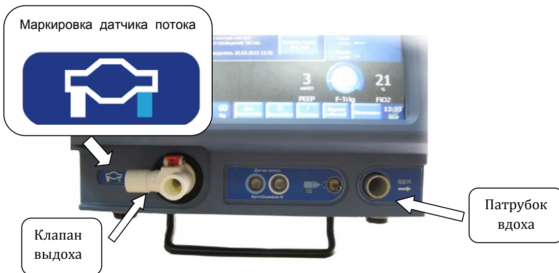
Рис. 5-7. Порты подключения датчика потока и небулайзера.
