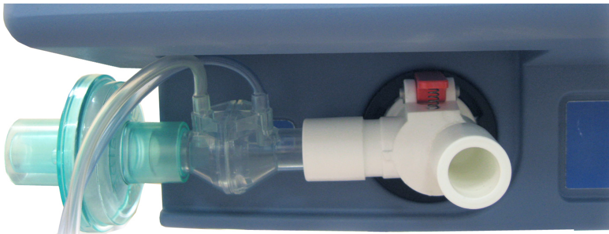
Рис. 5-9. Место положения клапана выдоха и датчика потока.
