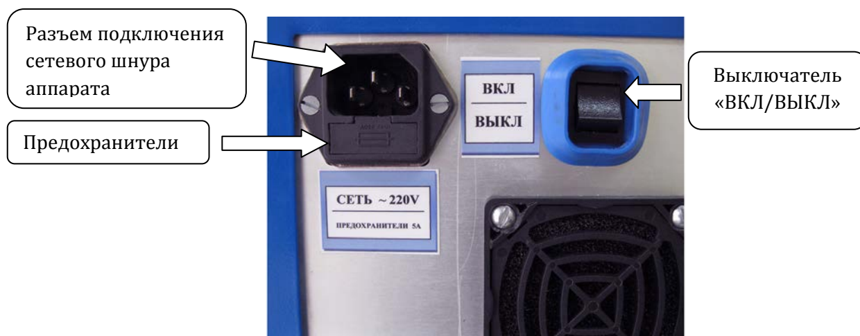
Рис. 5-2. Местоположения разъемов для подключения к электросети.
