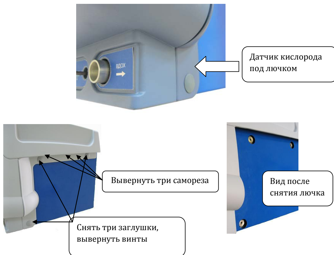
Рис. 15-1. Место размещения люка для доступа к датчику кислорода
